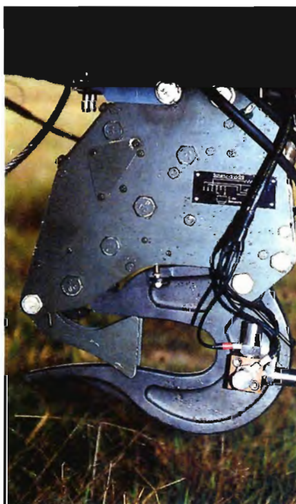
Capteurs sur crochet d'élingage
